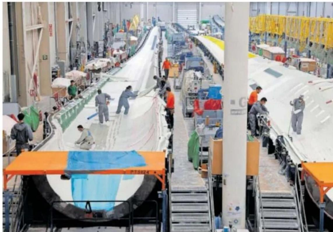
Construcción de palas de aerogenerador en la fábrica de Nordex en Lumbier (Navarra). V. WEST (REUTERS)
